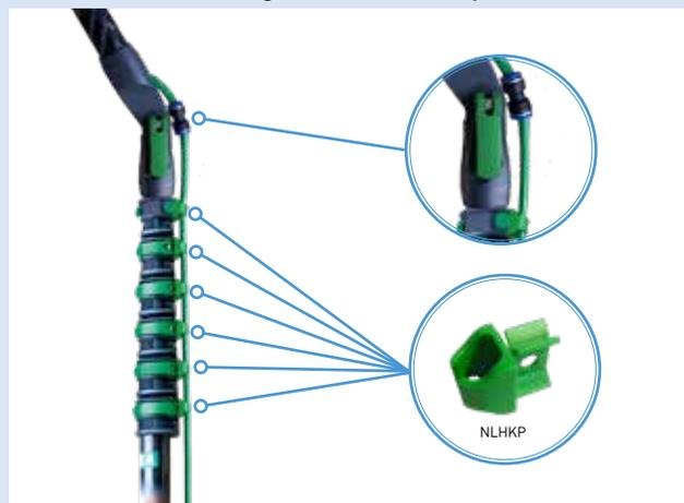
Insérez les colliers de serrage NLHKP dans les clips de la perche télescopique nLITE. Guidez le tuyau à travers les clips situés à l'extérieur de la perche et raccordez-le à l'adaptateur angulaire à l'aide du connecteur rapide sur l'adaptateur angulaire.
