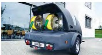
Adapté aux véhicules avec une charge de remorque allant jusqu'à 1 350 kg. Réservoir grand volume, intégré dans un châssis léger pour manœuvrer en toute sécurité. Homologation du TÜV, un essieu, freins intégrés, éclairage et clignotants. Livraison avec système d'attelage européen standard, roue de support, frein à main, ainsi qu'une béquille pour une meilleure stabilité. Conformité UE.
