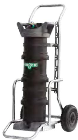
L'eau s'écoule à travers la résine échangeuse d'ions, qui lie les matières solides. Ainsi on produit de l'eau extrêmement pure, semblable à de l'eau distillée. La déionisation enlève 100 % des minéraux et permet ainsi une grande qualité de l'eau.
